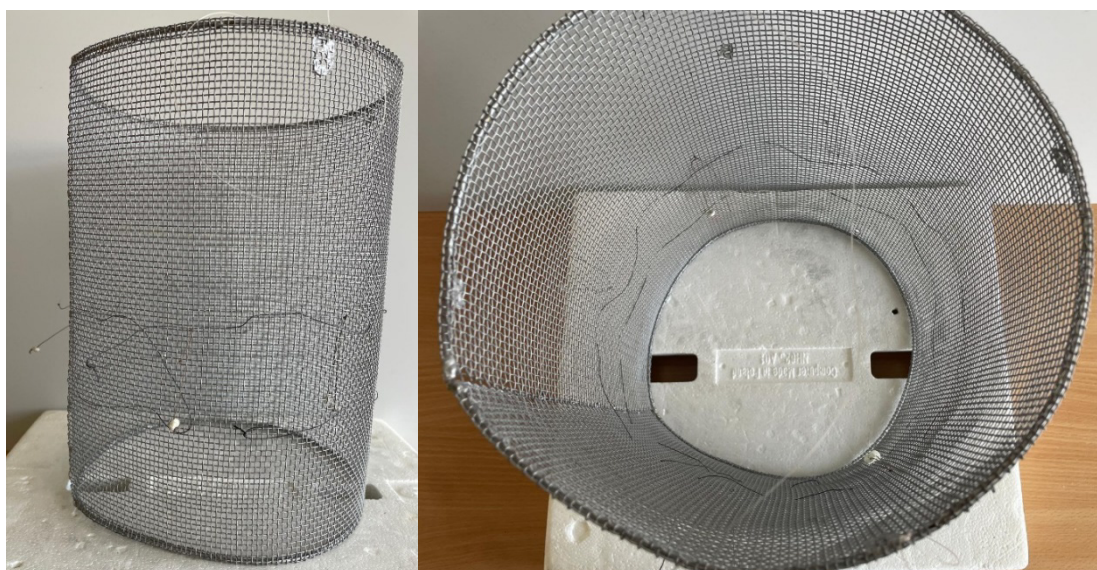
Obr. 1. Faradayova klec z pletiva (vlevo): Na levé straně je vidět zvednutá polystyrenová kulička; pohled dovnitř (vpravo): obě polystyrenové kuličky jsou spadlé.
